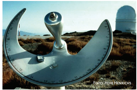
Figuur 2 Een precisie-zonnewijzer gemaakt op de Calar Alto in Spanje. De schaduwwerpende 'knotsvormige' poolstijl maakt de correctie voor de tijdvereffening mogelijk. De vorm van de poolstijl is die van het analemma. De rechte schaduw wijst MET nauwkeurig aan. Conventionele zonnewijzers hebben een staafvormige poolstijl, en wijzen dus de zonnentijd aan.
